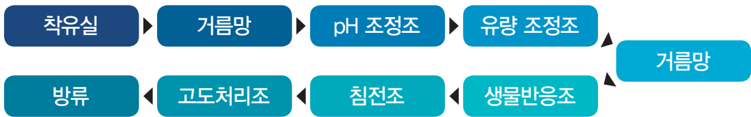
<그림 3.4> 착유 세정수 정화처리 시설 설치 순서도
